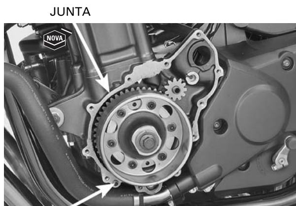
JUNTA PINO-GUIA TAMPA DO ALTERNADOR
