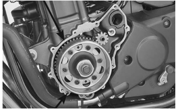
PINO-GUIA ENGRENAGEM REDUTORA EIXO DA ENGRENAGEM
