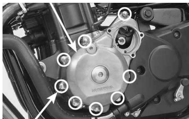
PARAFUSOS ENGRENAGEM REDUTORA DE PARTIDA
