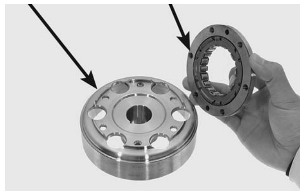
VOLANTE DO MOTOR EMBREAGEM DE PARTIDA
