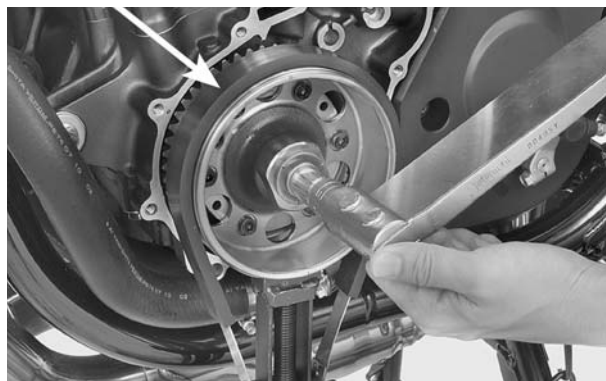
PARAFUSO ARRUELA VOLANTE DO MOTOR FIXADOR DE VOLANTE DO MOTOR
